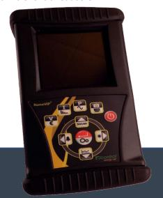
NanoVIP® TWO PLUS™ è un analizzatore della Qualità dell'energia portatile, compatto e potente per uso professionale; può essere utilizzato su reti monofase, bifase, trifase bilanciate, in bassa e media tensione.
